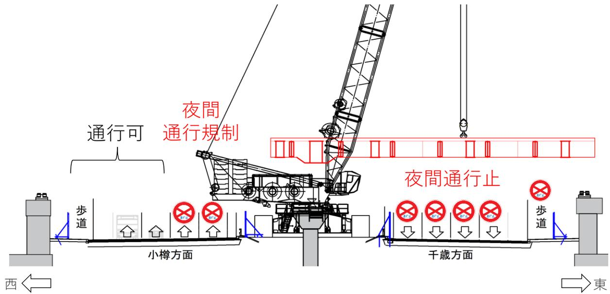
■工事箇所断面図 北進線（小樽方面）を通行止めする場合
